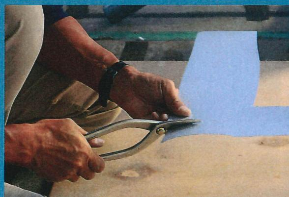
金属加工(建築板金法)における基礎・専攻学科と併せて器工具・機械操作等の使用方法を学び、様々な板金製品の展開から組立、検査等の実習を行い、一貫作業ができる実践的な技能を習得します。
